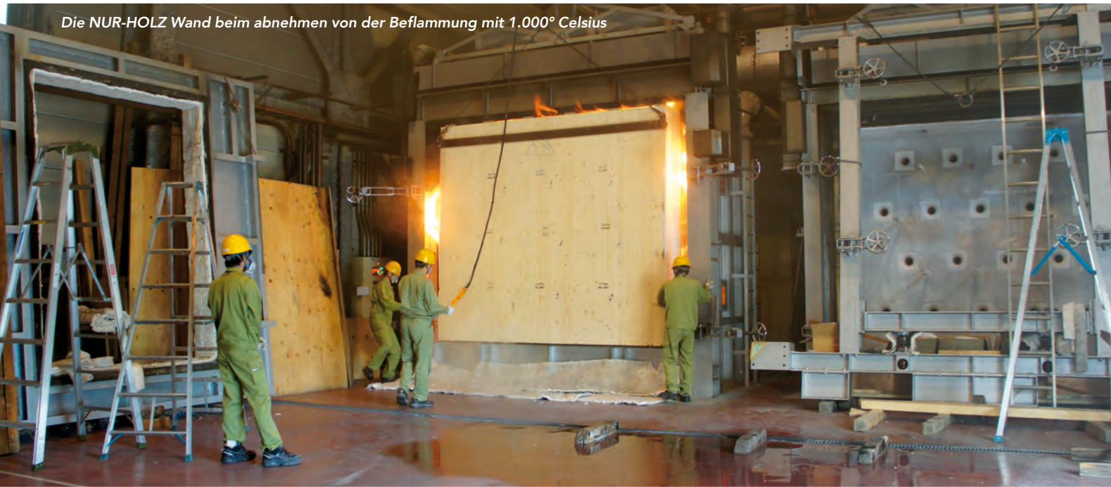
Nach einer Stunde Beflammung nur an der Oberfläche geringer Abbrand
